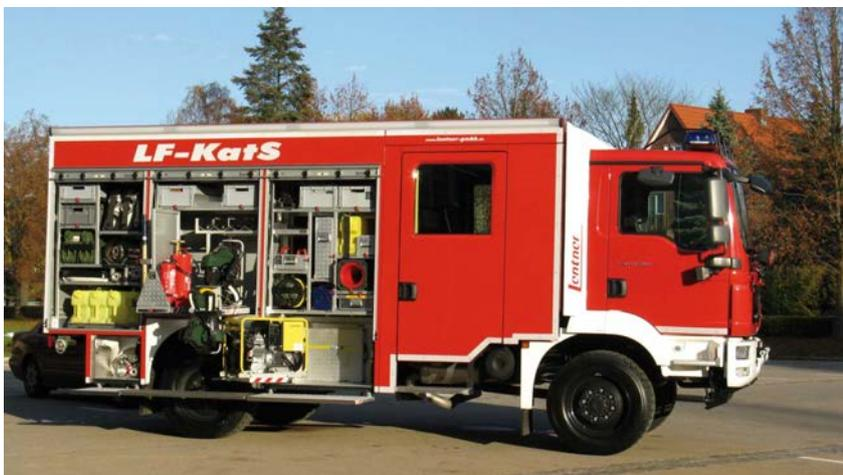
Aufbau Firma Lentner Hohenlinden: Besatzung 9 Mann (eine Löschgruppe), Löschwassertank 2400 Liter, 4 Atemschutzgeräte im Mannschaftsraum zum Ausrüsten während der Fahrt, Akkubetriebener Druckbelüfter und Lichtmast, 3 teilige Schiebleiter und 4 teilige Steckleiter
